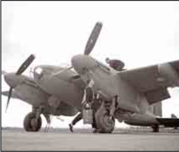
En çok hasar tolere edebilen uçaklardan olan Mosquito uçakları tahtanın kontrplak tabakaları arasında sıkıştırılmasıyla üretilmişlerdir.
